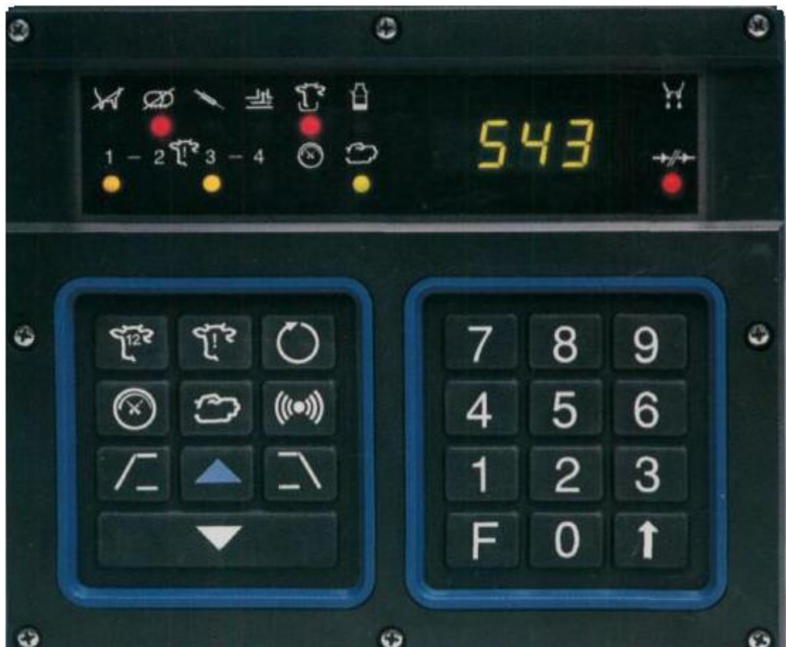
49 pav. Melžimo aikštelės kompiuterio valdymo skydas.
