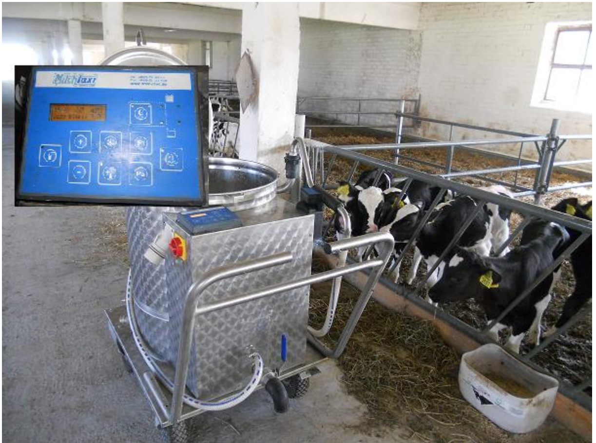
93 pav. Grupiniai veršelių gardai ir pieno pakaitalo ruošimo katilas su valdymo ekranu.
