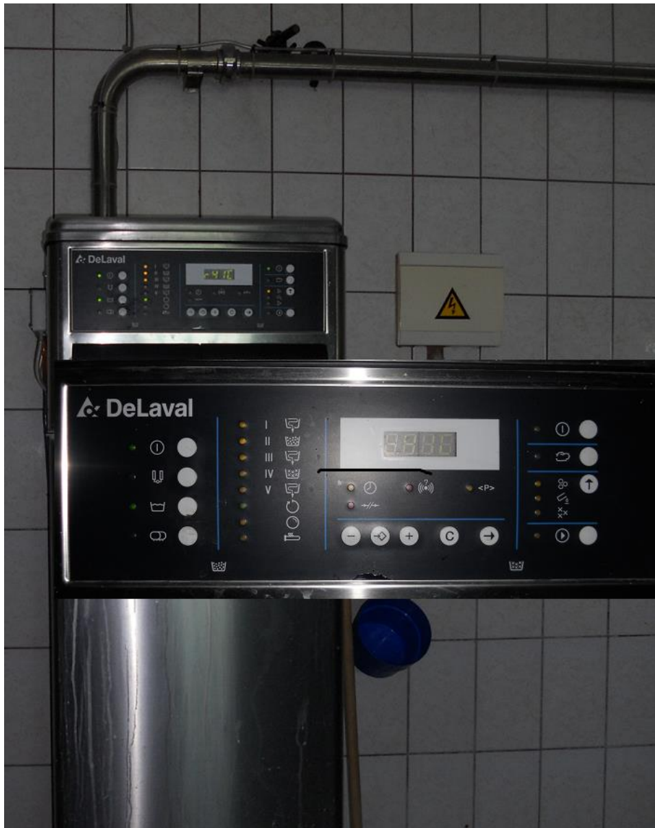
45 pav. Delaval firmos pieno inventoriaus ir įrenginių plovimo bei dezinfekavimo automatas ir jo valdymo ekranas.
