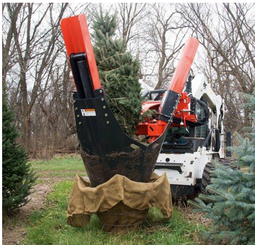
29pav. Mašinos, skirtos sodmenų, išaugintų atvirame grunte, iškasimui
