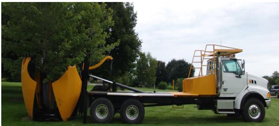
32pav. Didelių medžių persodinimo mašinos
