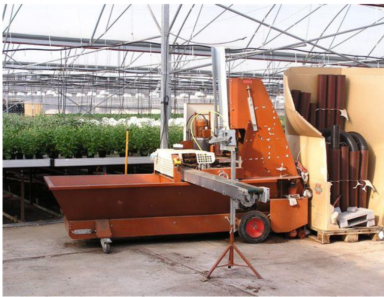
19pav. Mechanizuotas daigų persodinimas.
