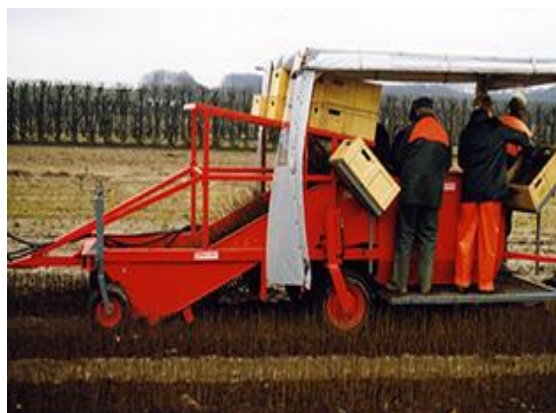
22pav. Sodinukų iškasimo kombainas
