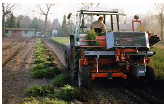
24pav. Sodinukų iškasimo kombainas
