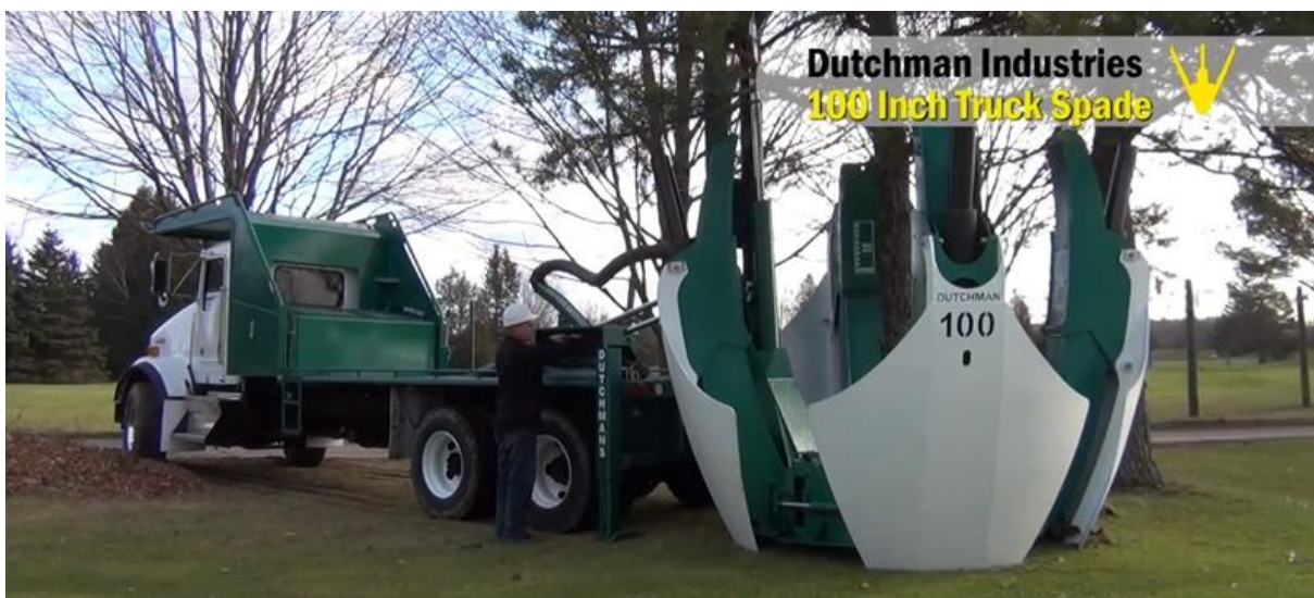
30pav. Medžių persodinimo hidraulinis priedas
