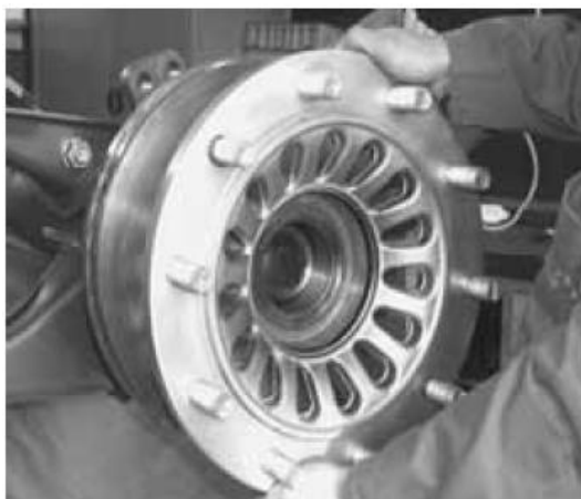
41 pav. Stebulės montavimas
