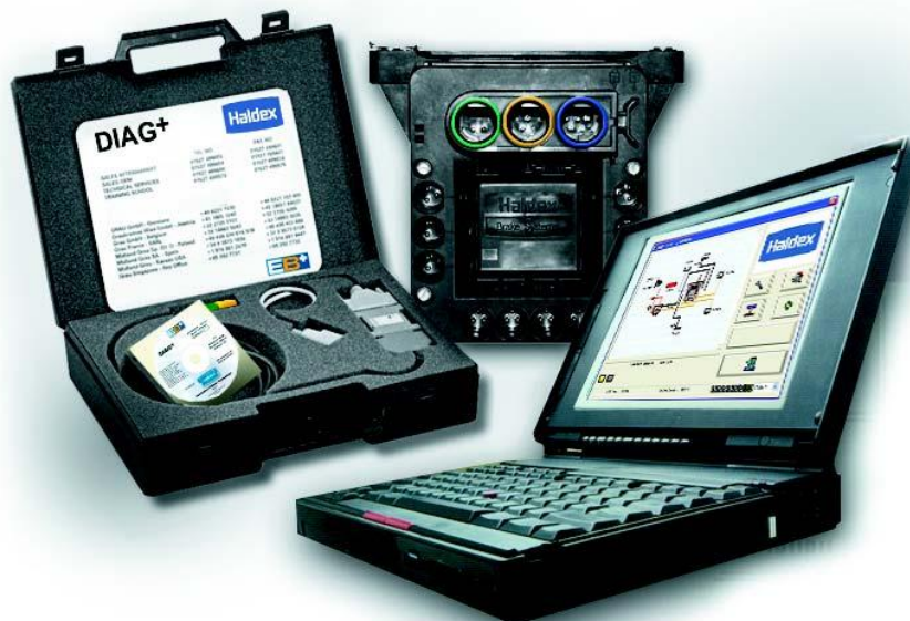
11 pav. Sunkvežimių ir puspriekabių stabdžių elektronikos diagnostikos įranga „HALDEX“
