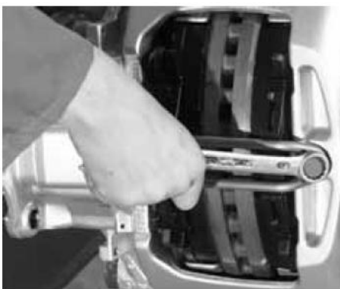
20 pav. Kaladėlių atraminio laikiklio atraminį varžtą atsukimas
