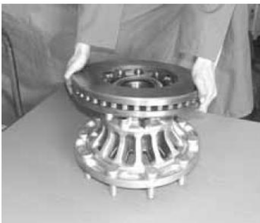
56 pav. Stabdžių disko uždėjimas ant stebulės
