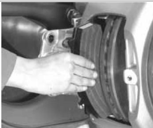
27 pav. Stabdžių kaladėlių montavimas
