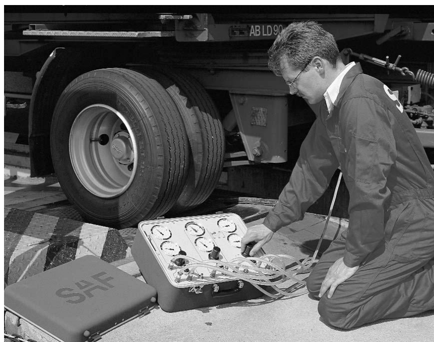
70 pav. SAF pneumatinės stabdžių sistemos slėgių patikra
