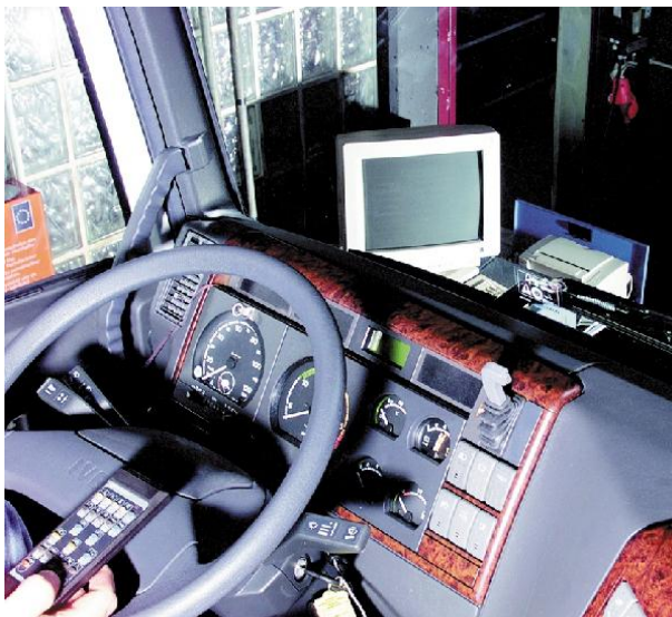
62 pav. Tachografų kalibravimas
