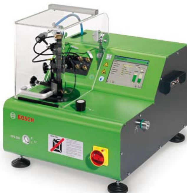
61 pav. Dyzeliniu purkštuku testavimo įrenginys EPS 200
