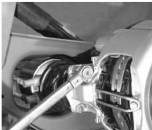
50 pav. Stabdžių cilindro montavimas prie stabdžių apkabos
