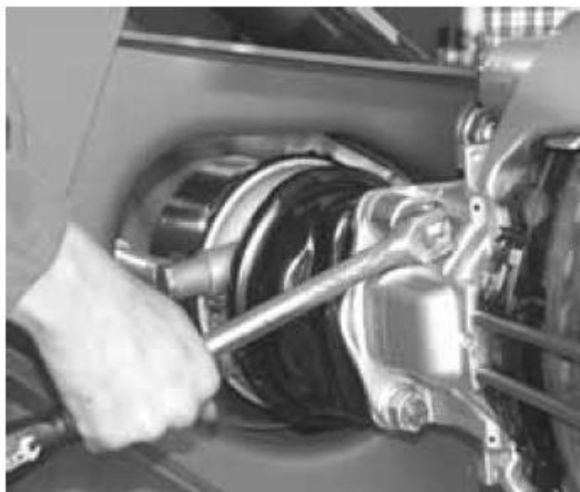
31 pav. Stabdžių darbinio cilindro nuėmimas
