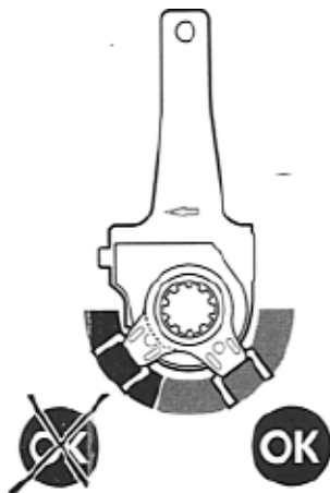
73 pav. SAF pneumatinių būgninių stabdžių automatinis trinkelio tarpelio reguliavimas
