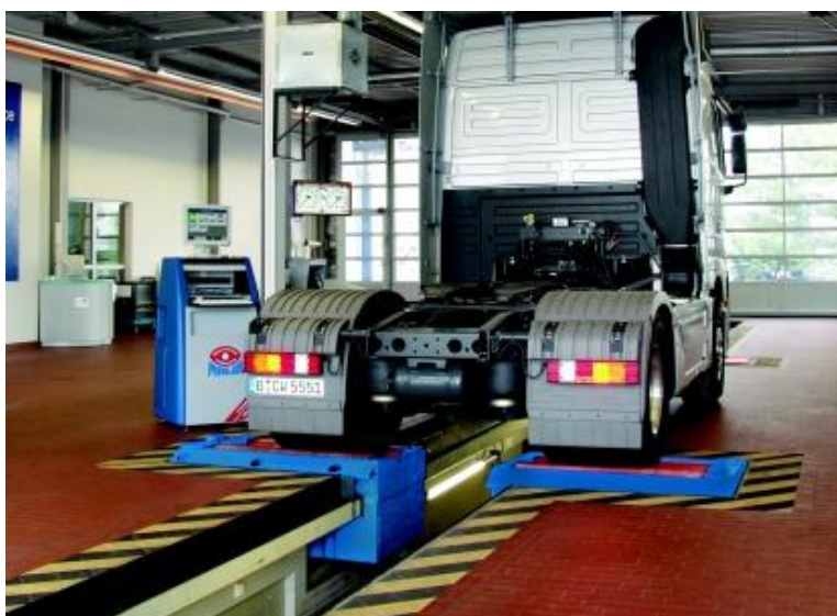
9 pav. Vilkiko ir priekabos stabdžių universali tikrinimo linija „EUROSYSTEM“
