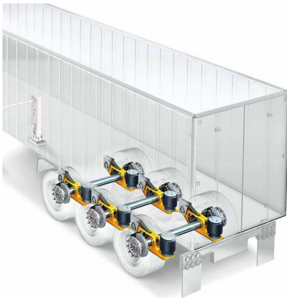
75 pav. Pneumatinė pakaba sumontuota puspriekabėje
