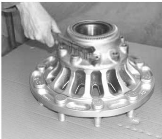
55 pav. Kontaktinio paviršiaus su disku valymas
