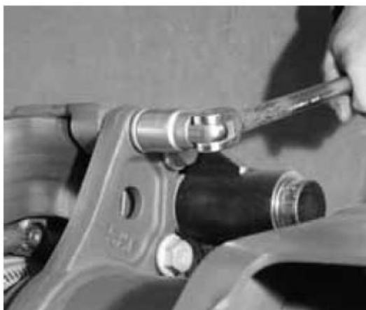
32 pav. Stabdžių apkabos laikančiųjų varžtų nuėmimas
