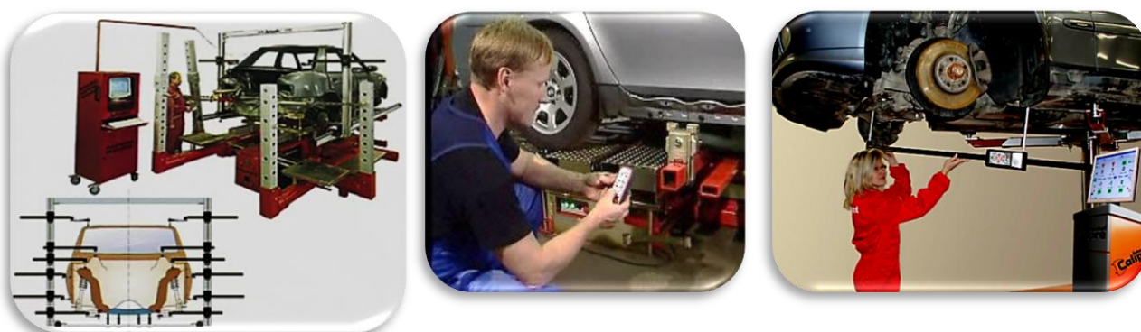
32 pav. Kėbulų geometrijos grąžinimo stendas „Autorobot“ su elektronine matavimo sistema ir distanciniu valdymu bei elektroninis matavimo prietaisas „Autorobot EzCalipre“
