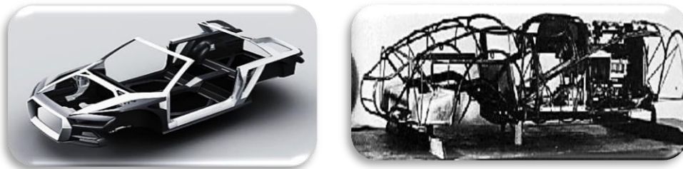
8 pav. Laikančiojo kėbulo „Audi Q“ ir pirmųjų BMW sportinių automobilių erdvinis rėmas
