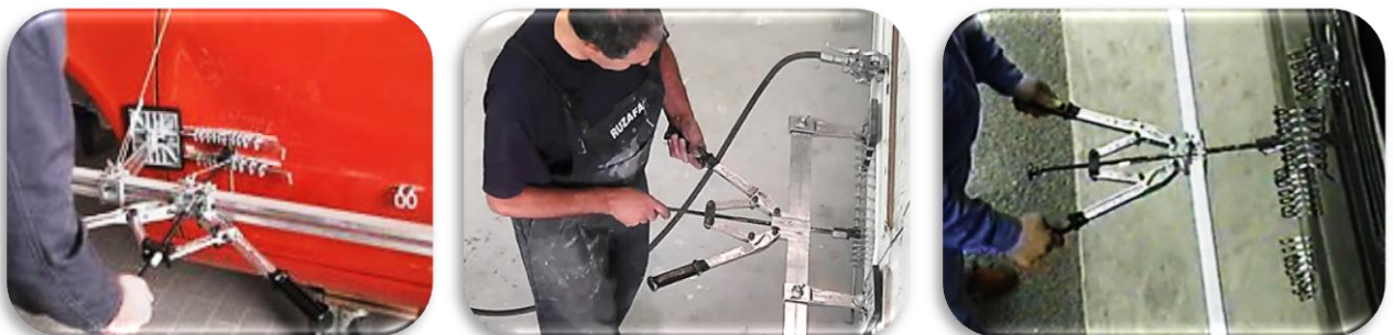
28 pav. Didelių deformacijų šalinimas tempimu privirinant tempimo elementus
