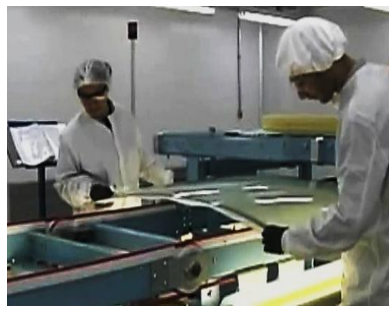
34pav. Ant vidinio stiklo klojama plėvelė ir uždengiama kitu stiklu
