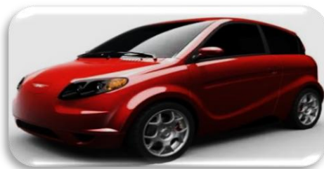
21 pav. „Kestrel EV“ kėbulas pagamintas iš kanapių pluošto
