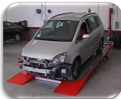
31 pav. „Blakchawk“ firmos kėbulo geometrijo grąžinimo patobulintas stendas „Power Pro.mp4“
