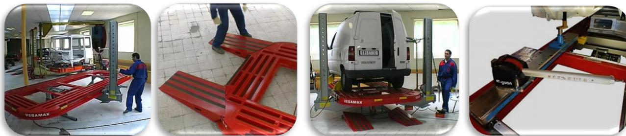
32 pav. Patobulintas „Celette Vegamax“ kėbulo geometrijo grąžinimo stendas ir elektroninis matavimo prietaisas
