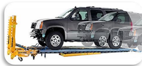
1 pav. Automobilio kėbulo geometrijos matavimo elektroninė sistema
