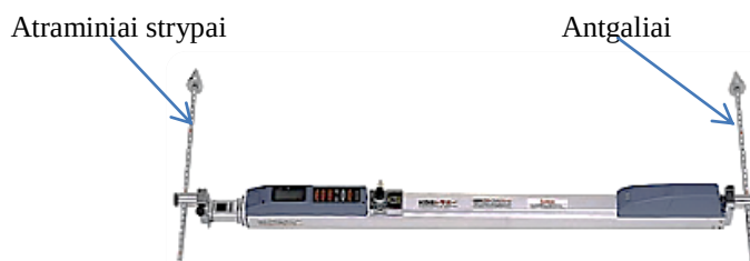
23 pav. Teleskopinė liniuotė „Car – O-Tronic“
