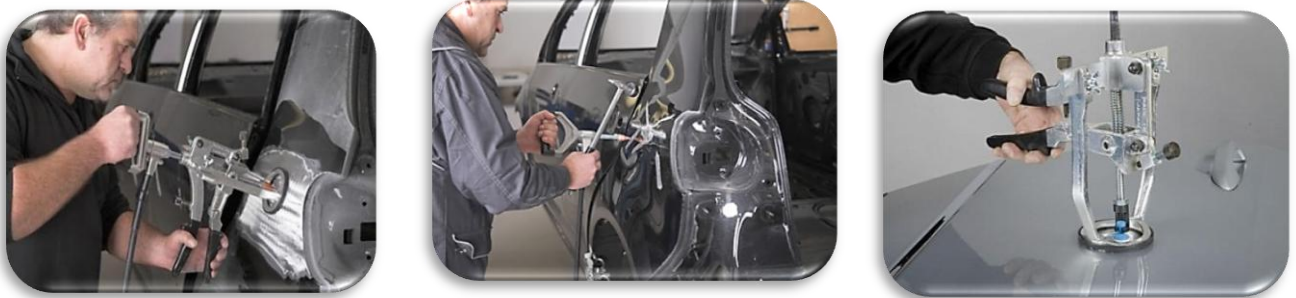
27 pav. Mažų deformacijų šalinimas tempimu privirinant elektrodą ir priklijuojant minkštą tempimui elementą
