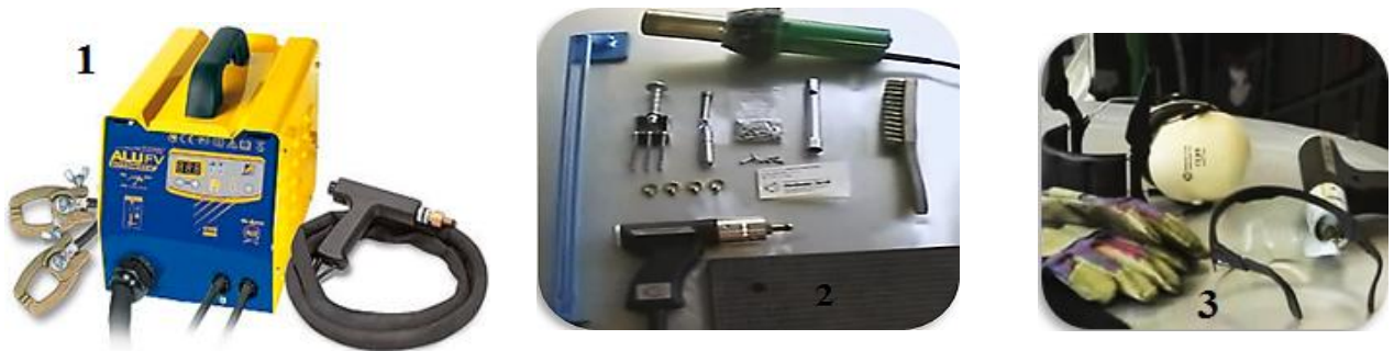
62pav. Deformacijų lyginimo aparatas 1, reikalingi įrankiai 2, individualios apsaugos priemonės 3
