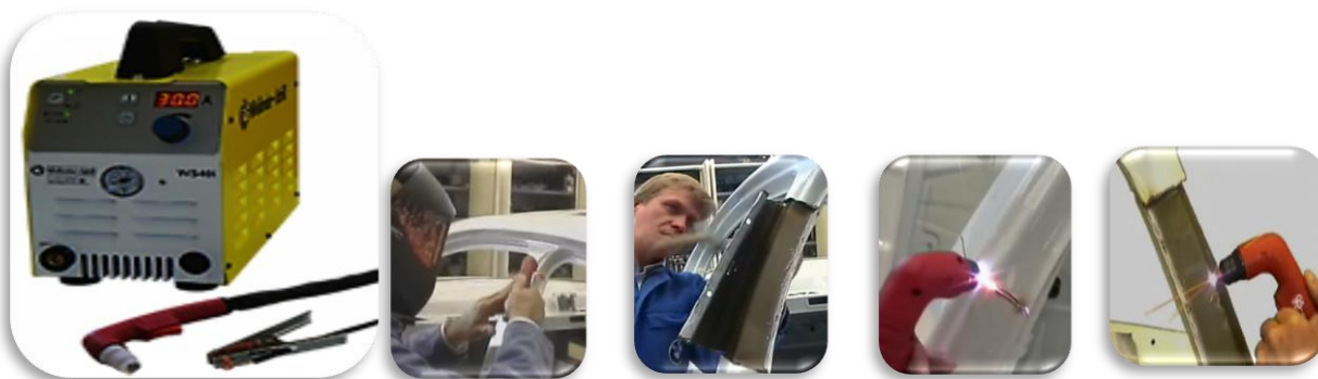
22 pav. Pjovimo prietaisu „Plasma-Cutter WS 40i“ neperpjaujami apatiniai sluoksniai
