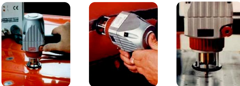
42 paveikslėlis. Įdubos, juostinio įlenkio ir išgaubos šalinimas
