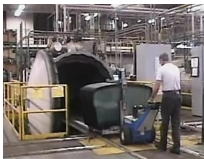
35pav. Paruošti stiklai dedami į įtvarus ir patalpinami į autoklavą
