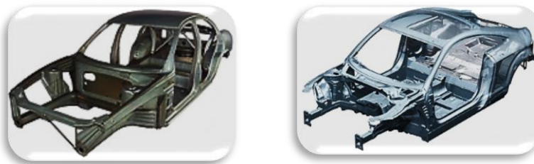
10 pav. Laikantysis „Audi“ monokokinis kėbulas
