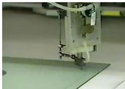
33 pav. Išpjaunami reikiamos konfigūracijos stiklo lakštai ir formuojamas automobilio stiklas
