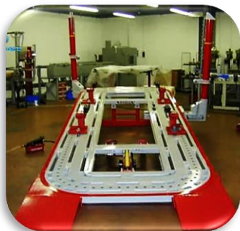
31 pav. „Blakchawk“ firmos kėbulo geometrijo grąžinimo patobulintas stendas „Power Pro.mp4“
