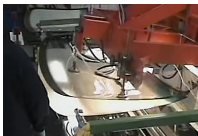
35pav. Ant stiklo klojama plėvelė ir uždengiama kitu stiklu ir suspaudžiamas
