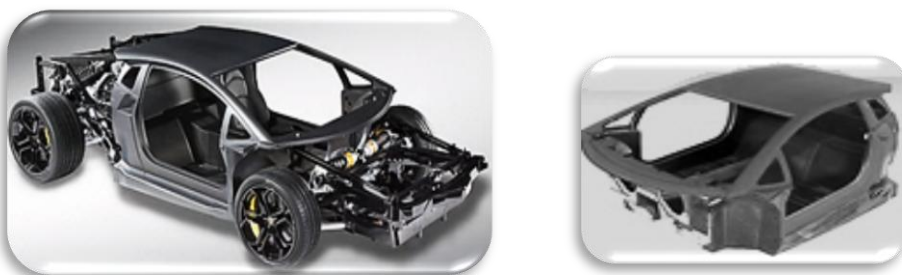
9 pav. Laikantysis „Lamborghini Aventador V12“ monokokinis kėbulas
