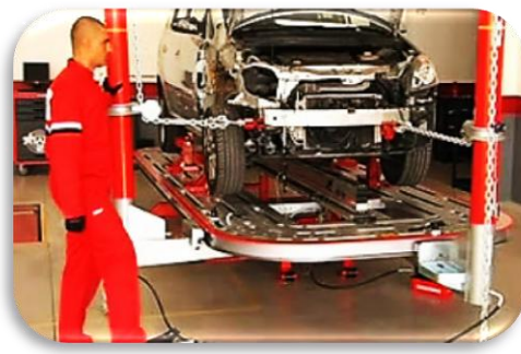
31 pav. „Blakchawk“ firmos kėbulo geometrijo grąžinimo patobulintas stendas „Power Pro.mp4“
