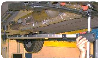
26 pav. Automobilio dugno matavimas įstrižainėmis
