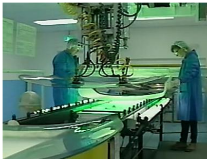
34pav. Ant vidinio stiklo klojama plėvelė ir uždengiama kitu stiklu
