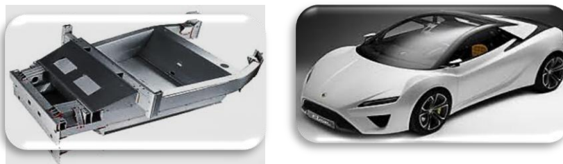
6 pav. Netradicinė laikančiojo kėbulo konstrukcija
