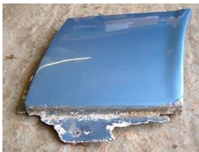
33 pav. Aliumininis priekinis sparnas paveiktas oksidacijos
