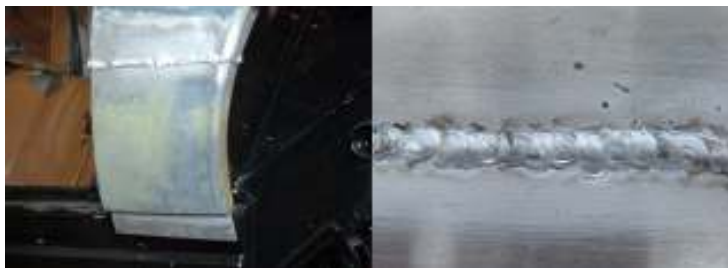
35 pav. Aliuminio automobilio kėbulo sparno virinimas
