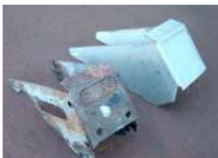
24 pav. Pagaminta detalė pagal turimą šablono formą
