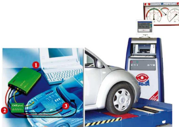
17 pav. Automobilio elektroninių valdymo ir mechaninių sistemų diagnostika: a) elektroninių valdymo sistemų diagnostika 1 - kompiuteris, 2 - diagnostikos prietaisas, 3 - automobilio elektroninės sistemos valdymo blokas (EVB), b) automobilio pakabos ir stabdžių diagnostikos stendas
