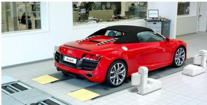
10 pav. Važiuklės – pakabos tikrinimo standas.
