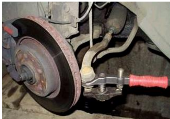
7. pav. Antgalio išpresavimas
