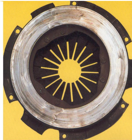
Pav. 71. Perkaitintas prispaudimo disko darbinis paviršius
