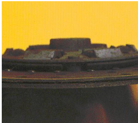
Pav. 69. Netolygiai nusidėvėjęs sankabos diskas
