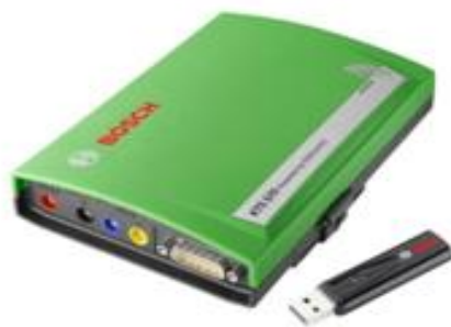
Pav. 82. Diagnostinis adapteris su 2 kanalų oscilografo funkcijom KTS570
