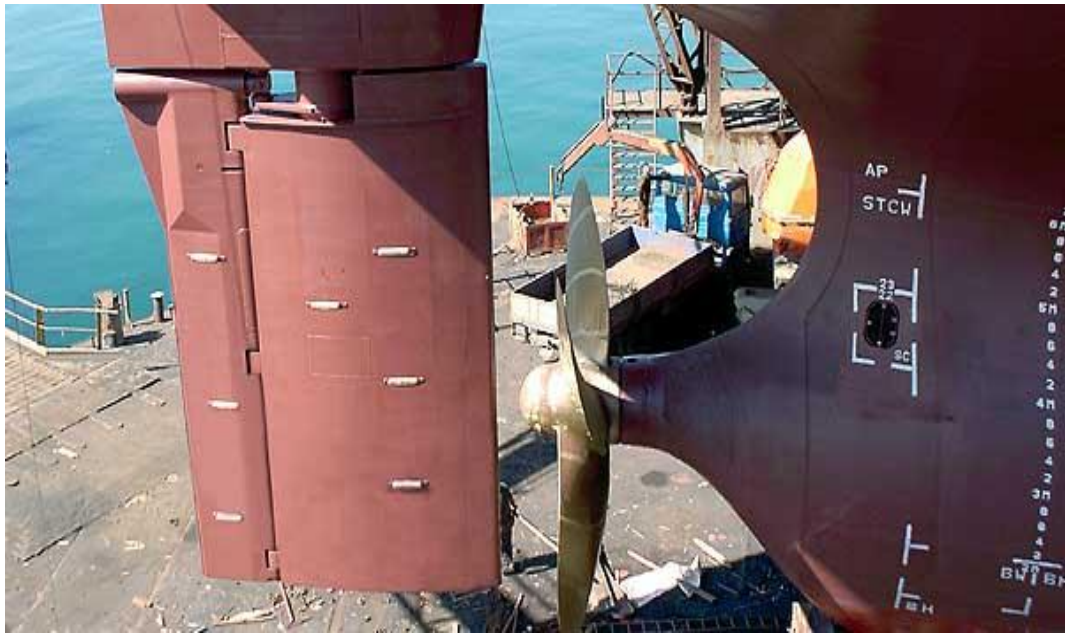
41 pav. Vairas su antvairiu, kurio posūkis plaukiant mažu greičiu galimas iki 75^\circ
