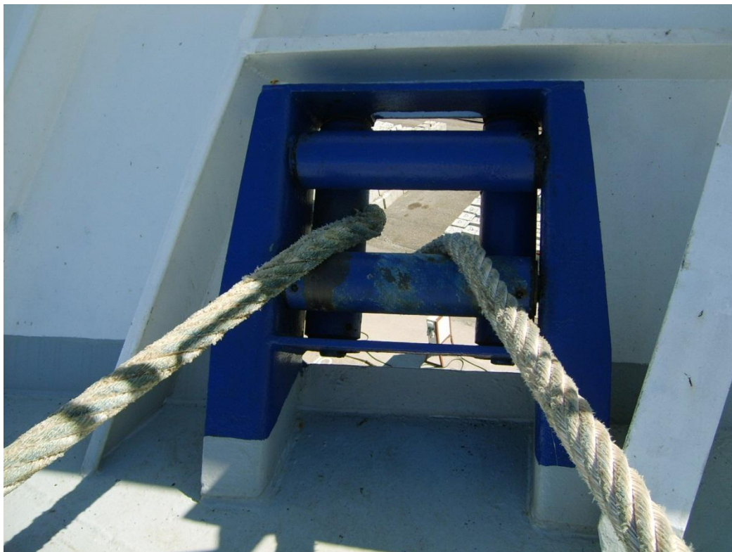
20 pav. Padidintos laikymo jėgos kluuzas su besisukančiais elementais (roulsais).
