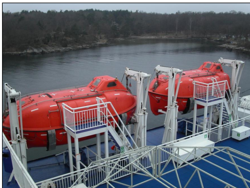
Pav. 4 gelbėjimosi valtys , po 2 kiekviename borte. Kiekvienos valties talpumas yra 43 žmonės.
