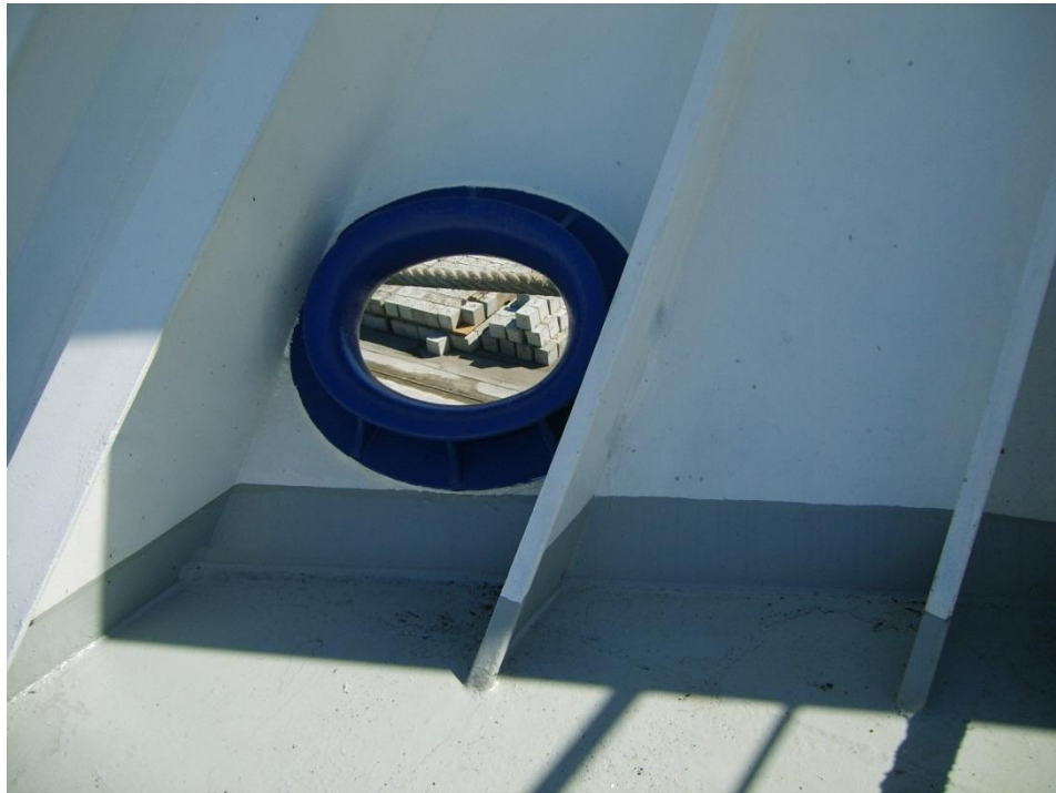
18 pav. Tipinis švartavimo kliuzas be besisukančių dalių.
