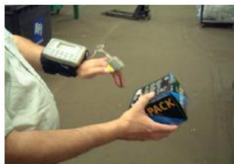
Surinkimas RF terminalais
