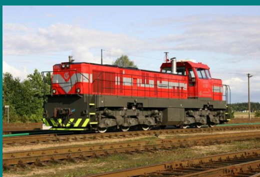
Šilumvežis ČME3M (VDV – CAT 3512B, 1455 kW)
