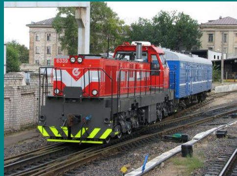
Šilumvežis ČME3M c (VDV – CAT 3508B, 970 kW)
