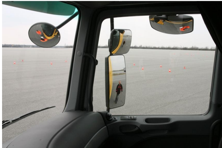
74 pav. Dešinės pusės veidrodžių sureguliojimas
