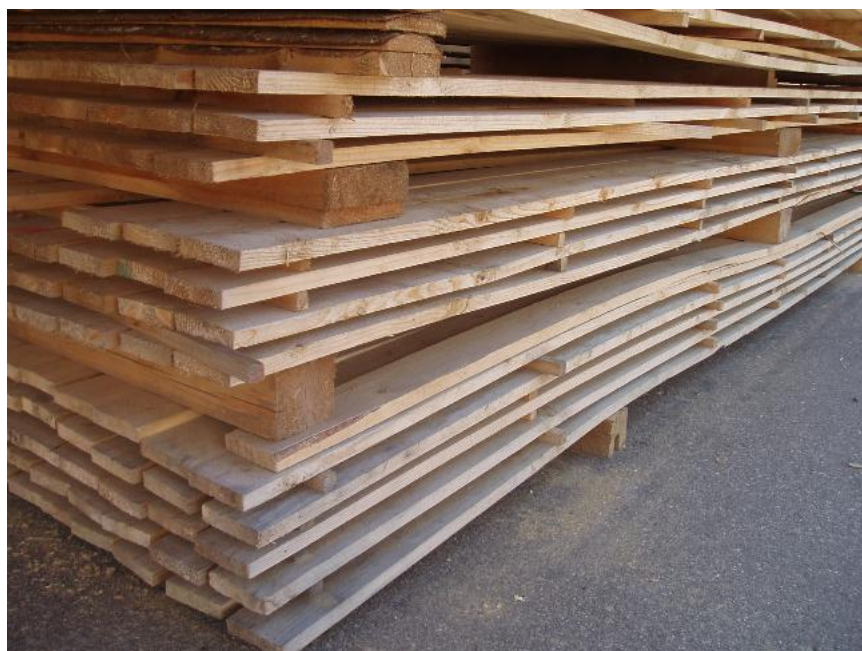
52 pav. Neteisingai suformuota rietuvė
