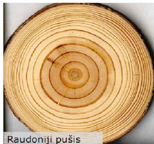
19 pav. Medienos struktūra makroskopiniame lygmenyje: pušis ir raudonoji pušis
