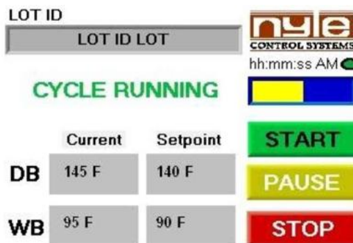
92 pav. Medienos džiovavimo duomenys lengvai sukonfigūruojami tiesiog ekrane, kuriame matoma ir valdoma džiovavimo proceso eiga
