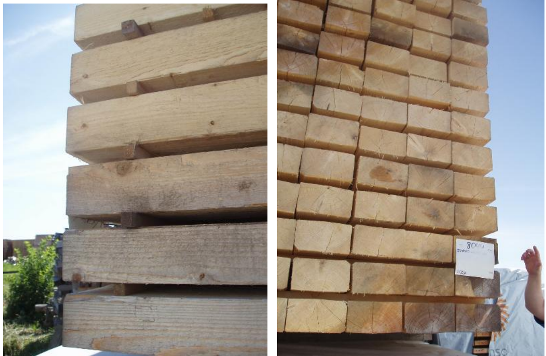
54 pav. Storesnės nei 40 mm medienos krovimas
