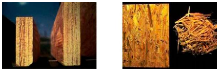
15 pav. Medienos lukšto sluoksniniai (a); orientuotųjų skiedrų plokštės (b)
