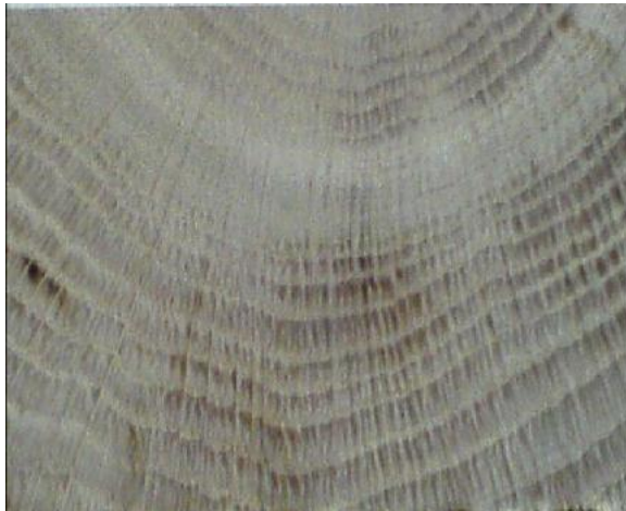
18 pav. Medienos struktūra makroskopiniame lygmenyje: qžuolas ir uosis
