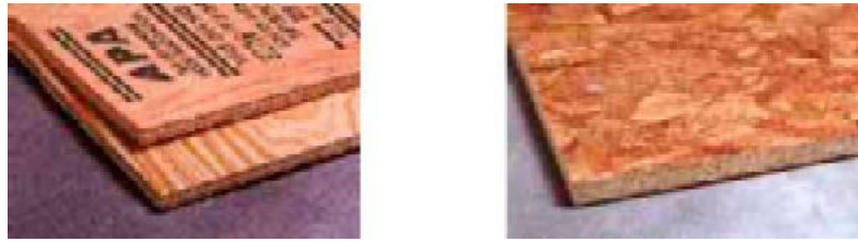
11 pav. Statybiniai medienos skydai: a – klijuotinė fanera; b – OSB.
