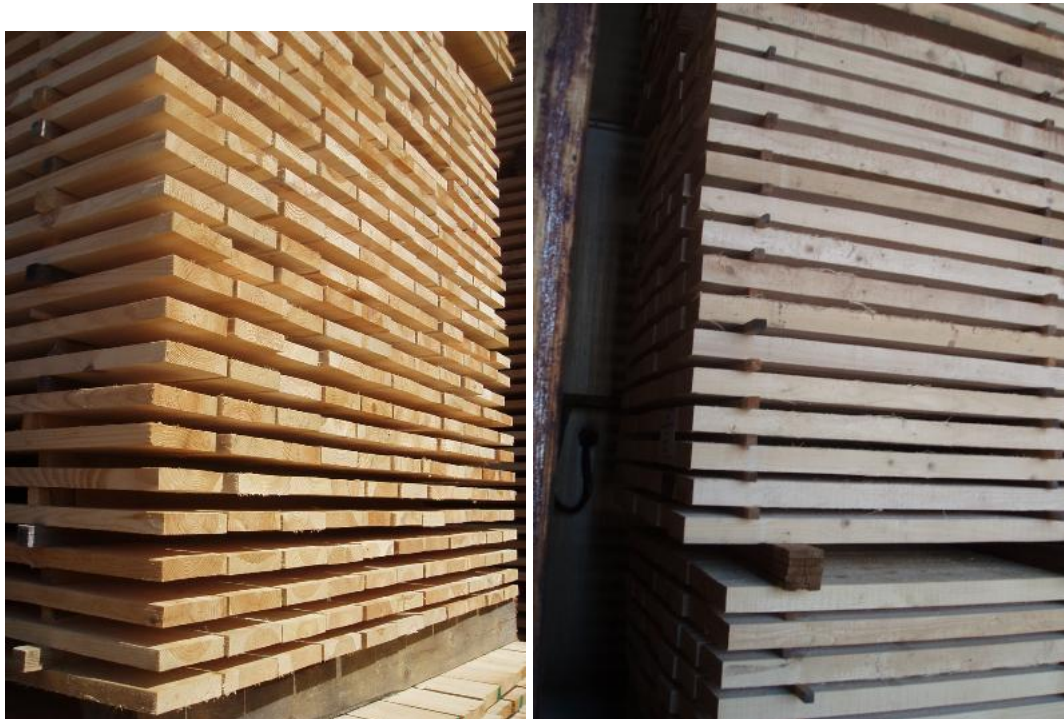
50 pav. Į džiovyklą talpinama mediena turi būti tos pačios rūšies ir storio.
