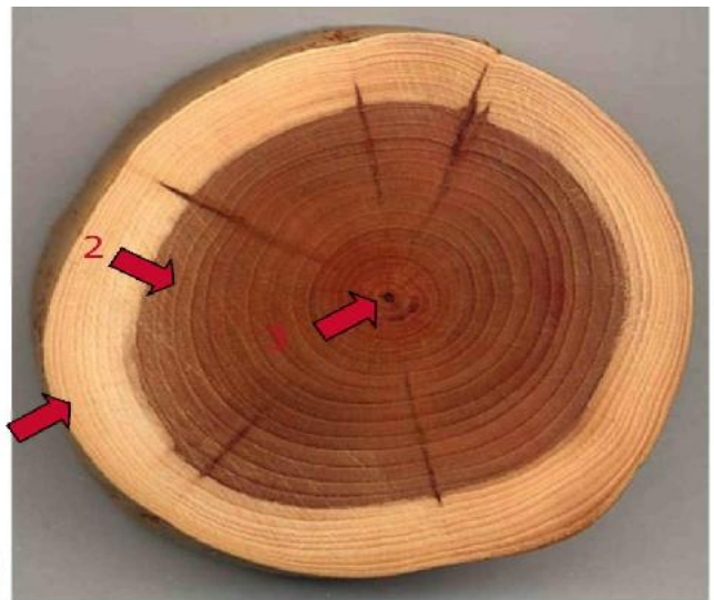
25 pav. Medienos struktūra makroskopiniame lygmenyje
