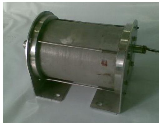
62 pav. Elektros variklis apsaugotas nerūdijančio plieno korpusu
