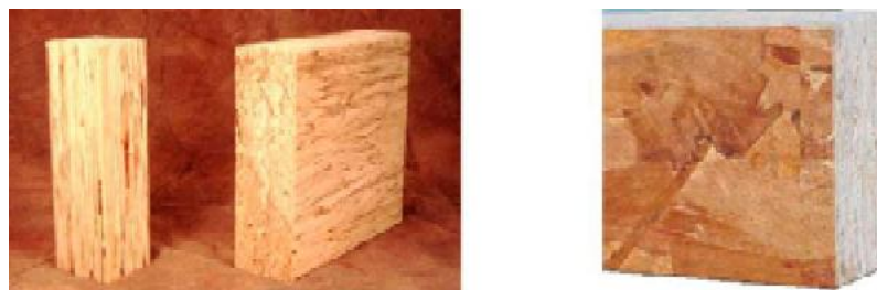
16 pav. Lygiagrečiųjų skiedrų (a) ir orientuotųjų skiedrų sortimentai (b)
