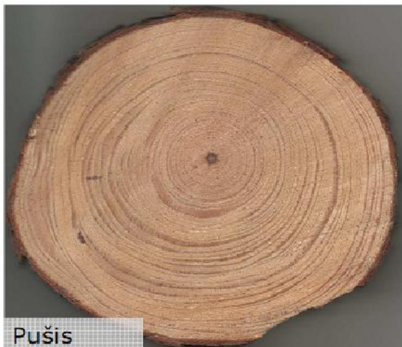
19 pav. Medienos struktūra makroskopiniame lygmenyje: pušis ir raudonoji pušis
