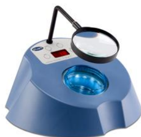
S.6.47. pav. Kolonijų skaičiuotuvai SC6PLUS.
