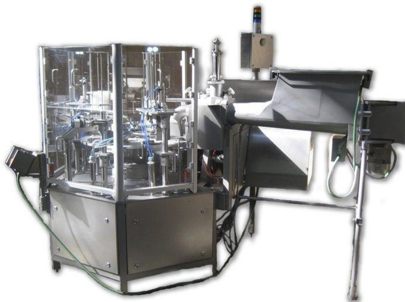
S.6.27. pav. Fasavimo įrenginys ARI-M: dozavimas 300 – 500 g, našumas nuo 15 iki 40 indelių per minutę.
