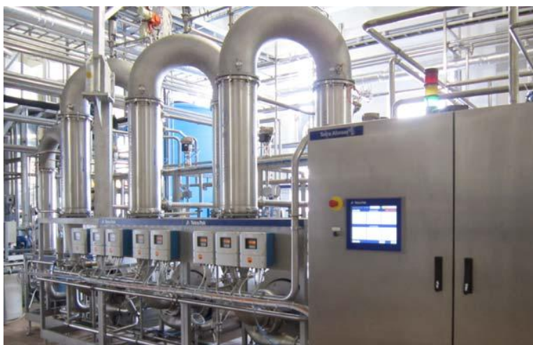
B.6.17.pav. Tetra Alcross M pieno valymo įrenginys
