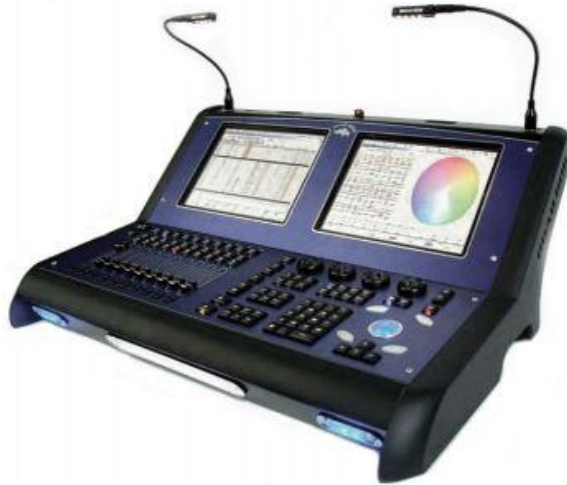
73. pav. HIGH END ROAD HOG Apšvietimo pultas
