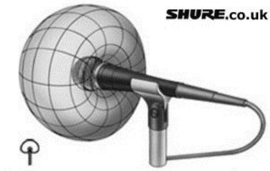
3.pav. Kardiodės kryptinė diagrama
