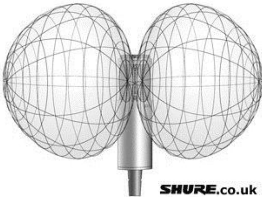
4.pav. Dvikryptė kryptinė diagrama
