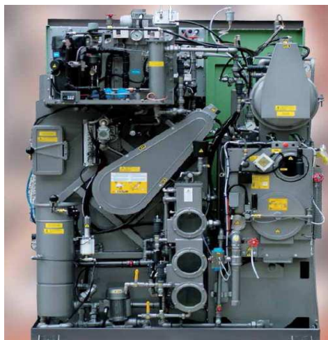
1 pav. Moderni cheminio valymo mašina su Hydrocarbonu
