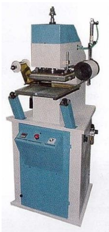
4. pav. Naujausias rašto įspaudimo ir auksavimo presas
