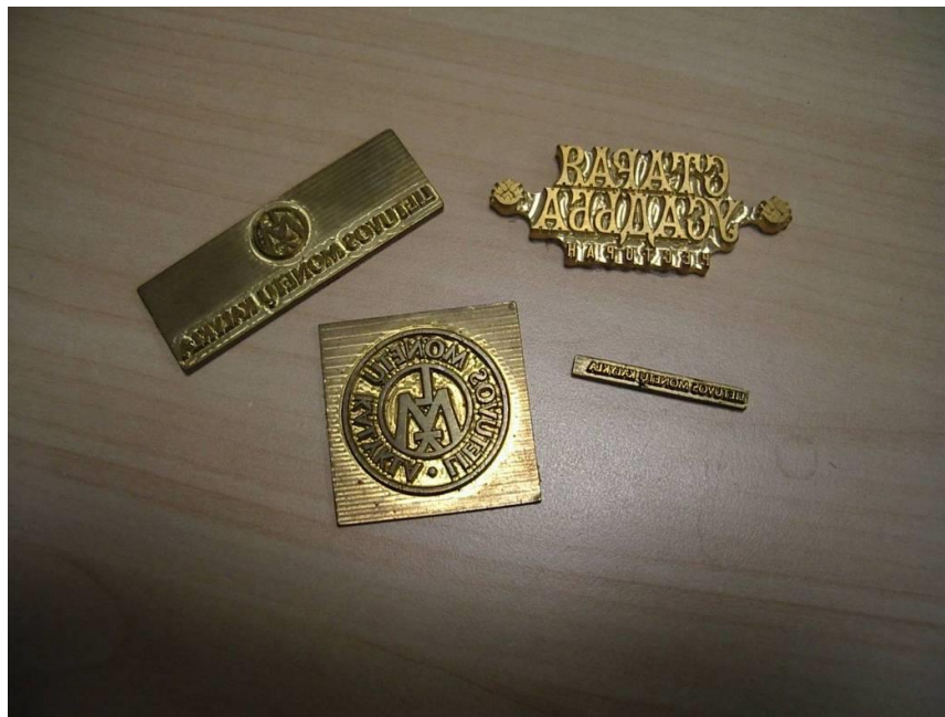
9. pav. Graviruotos žalvarinės klišės.
