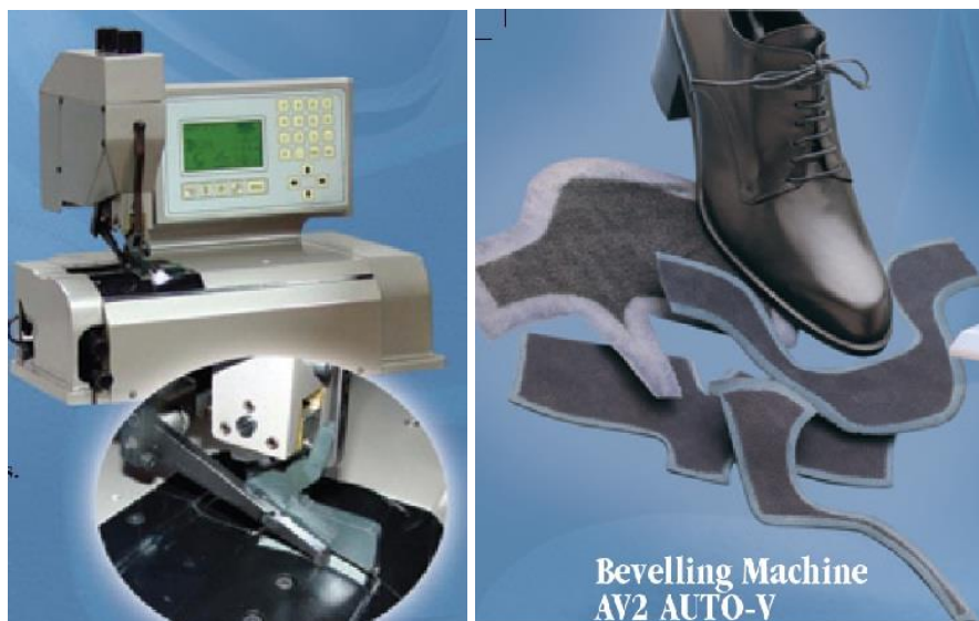
24. pav. Detalių kraštų ploninimo automatinis reguliavimas
