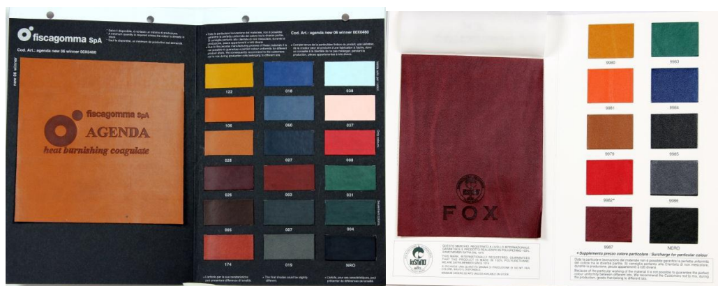
2. pav. Dirbtinė oda padengta PU plėvele (Lenkija)
