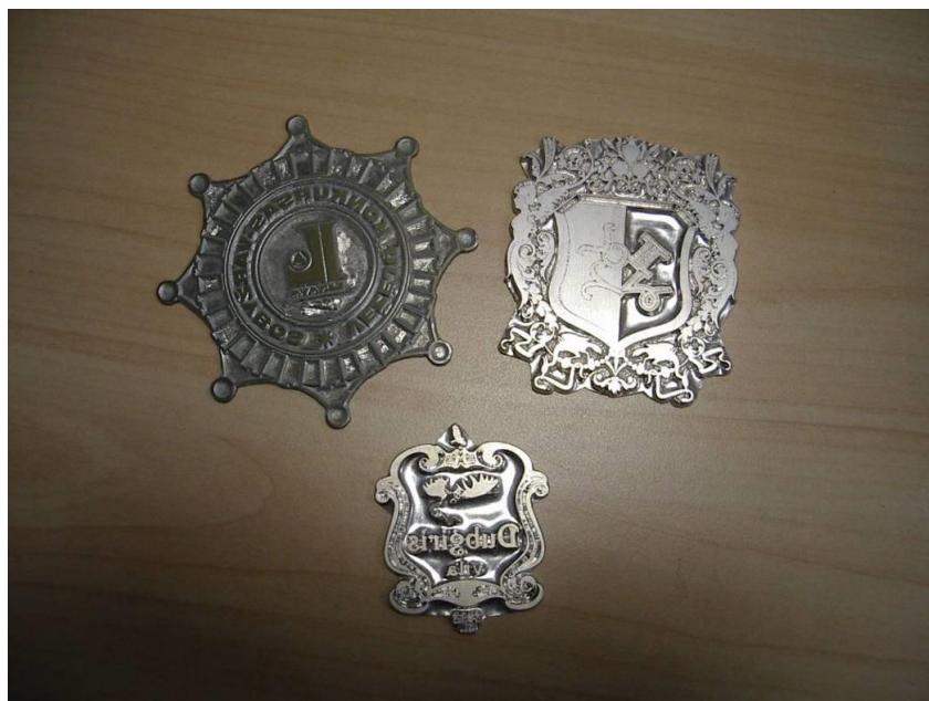
8. pav. Ėsdintos plastikinės klišės
