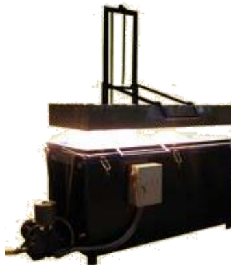
79 pav. 3 žingsnis: formų kaitinimas iki darbinių temperatūrų.
