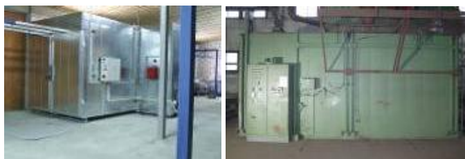
120 pav. Miltelinio dažymo kamera (krosnis).
