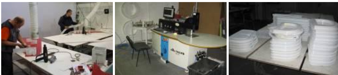
94 pav. Vakuuminio formavimo procesas; vakuuminio formavimo įrenginys; iš plastiko suformuotos raidės.
