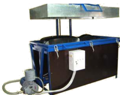
85 pav. 9 žingsnis: lakšto formavimas.
