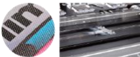
127 pav. Spausdinimas ant tinklelio: į specialų rašalo dėklą surenkamas rašalo perteklius, kuris prateka per tinklelį, tad išvengiama perteklinio rašalo nutekėjimo.
