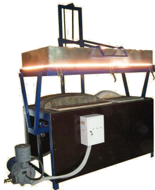
84 pav. 8 žingsnis: lakšto kaitinimas iki formavimo temperatūros.
