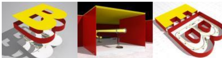
105 pav. Išorinės šviečiančios reklamos montavimo pavyzdys.
