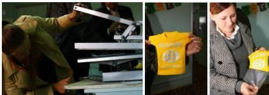
75 pav. Reklaminio produkto gaminimo procesas naudojant termotransferinį presą.
