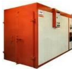
119 pav. Miltelinių dažų polimerizacijos krosnis „TG-0200 Electron“.
