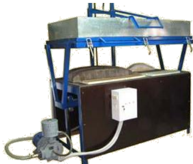
83 pav. 7 žingsnis: prispaudimo rėmo pakėlimas.
