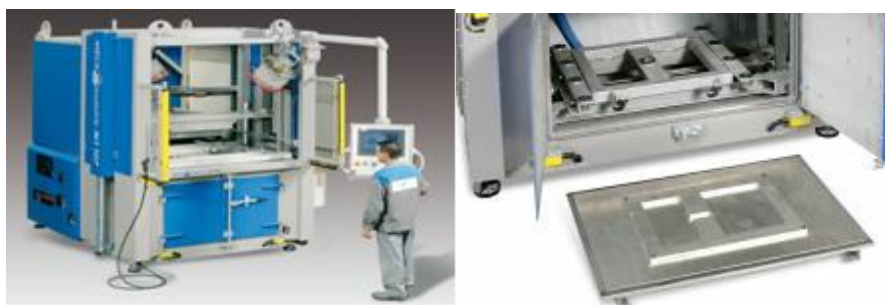
91 pav. CNC koordinatinės vakuuminio formavimo staklės.
