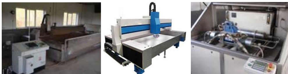
112 pav. CNC pjovimo vandeniu koordinatinių staklių sistema.
