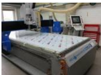
57 pav. Skaitmeninis frezavimas. Stalo matmenys: 1520 x 3050 mm.
