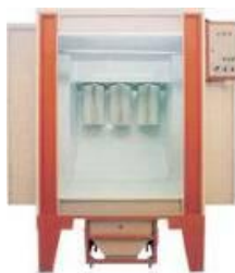
118 pav. Trijų filtrų dažymo kamera „Electron“.
