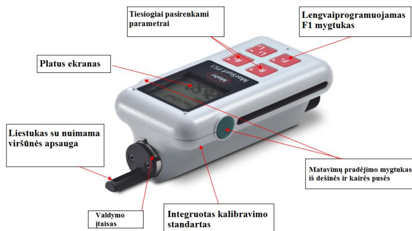
29 pav. MarSurf PS1 šiurkštimačio elementai
