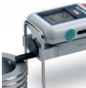
26 pav. Aukščio laikiklio MarSurf PS1 reguliavimas
