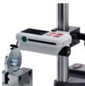
28 pav. MarSurf PS1 montavimas
