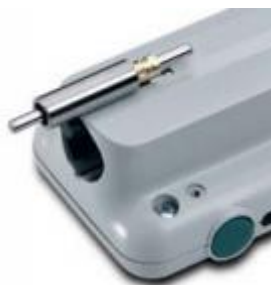
27 pav. Matavimas su apverstu šiurkštimačiu
