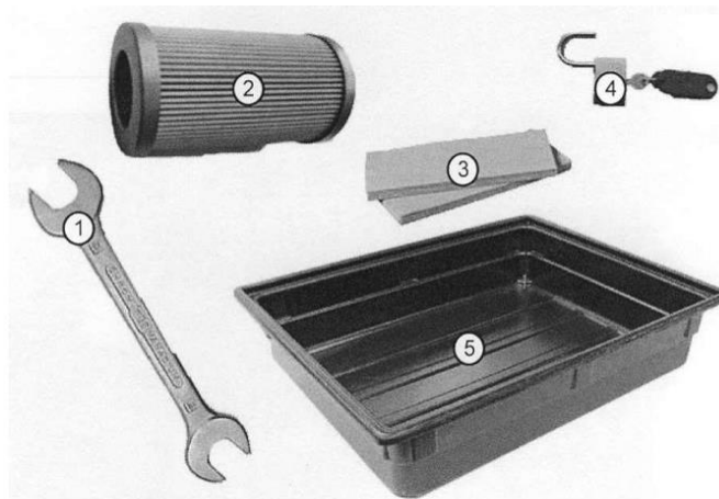
76 pav. Pagalbinės priemonės: 1- veržliaraktis, 2-nauja filtro tarpinė, 3-valomosios servetėlės, 4- spyna pagrindinio jungiklio užblokovimui, 5-alyvos surinkimo indas
