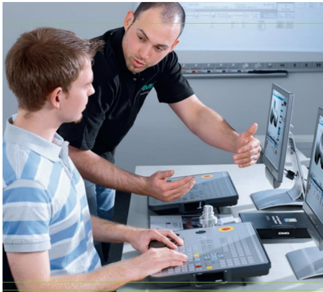
17 pav. Tekinimo staklių operatoriaus valdymo pultas bei analogiška programa kompiuterio ekrane, kaip realių-turimų staklių valdymo pulte.
