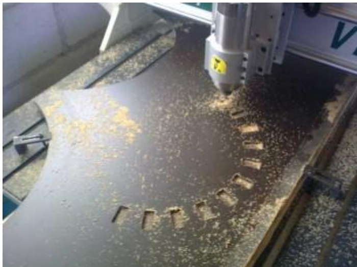
3pav. CNC frezavimo staklės frezuoja vėjo generatoriaus padą
