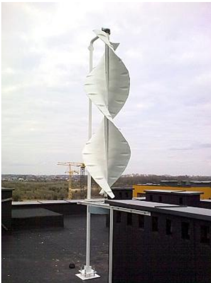
4pav. Tokia Lietuvos klimatui puikiai tinkanti "N Technologijų" suprojektuota vertikalioji vėjo jėgainė energiją pradeda gaminti pūstelėjus net ir silpnam (3m /s) vėjeliui.
