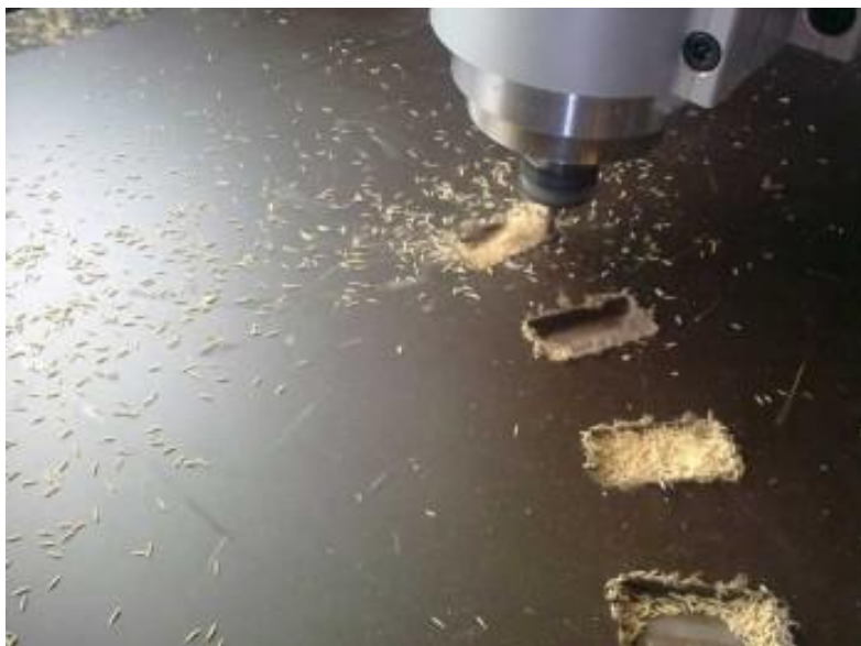
2pav. CNC frezavimo staklės frezuoja vėjo generatoriaus padą
