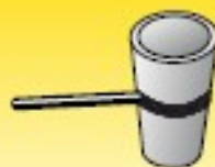
Horizontalioji, vamzdis nepasukamas, vamzdis lo ašis vertikaliąje padėtyje: PC/2G
