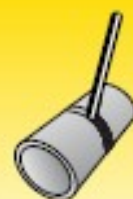
Vertikaliąjį aukštyn, vamzdis nepasukamas, vamzdis o ašis horizontalioje padėtyje: PF/5G
