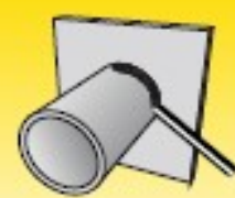
Vertikaliąjį žemyn, vamzdis nepasukamas, vamzdis lo ašis horizontalioje padėtyje: PG/5F (5Fd)
