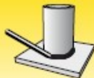
Vamzdis nepasukamas, vamzdis o ašis vertikaliąje padėtyje: PB/2F
