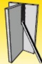
Vertikaliąjį žemyn: PG/3F
