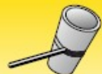
Vertikaliąjį aukštyn, vamzdis nepasukamas, vamzdis o ašis orientuota 45° kampu: H-L/45/6G
