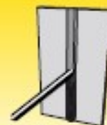
Vertikaliąjį aukštyn: PF/3G (3Gu)
