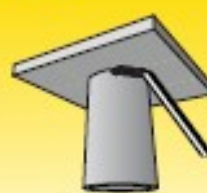
Lubinė, vamzdis nepasukamas, vamzdis lo ašis vertikaliąje padėtyje: PD/4F
