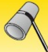
Vertikaliąjį žemyn, vamzdis nepasukamas, vamzdis o ašis horizontalioje padėtyje: PG/5G (5Gd)
