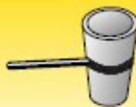
Horizontalioji, vamzdis nepasukamas, vamzdis o ašis vertikaliąje padėtyje: PC/2G
