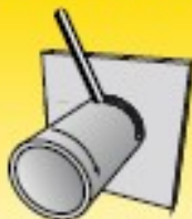
Vertikaliąjį žemyn, vamzdis pasukamas, vamzdis o ašis horizontalioje padėtyje: PB/2FR
