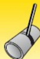
Vertikaliąjį aukštyn, vamzdis nepasukamas, vamzdis lo ašis horizontalioje padėtyje: PF/5G
