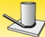
Vamzdis nepasukamas, vamzdis lo ašis vertikaliąje padėtyje: PB/2F
