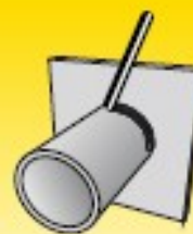
Vertikaliąjį aukštyn, vamzdis nepasukamas, vamzdis o ašis horizontalioje padėtyje: PF/5F (5Fu)
