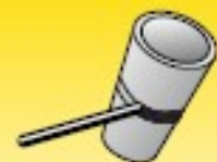
Vertikaliąjį aukštyn, vamzdis nepasukamas, vamzdis lo ašis orientuota 45° kampu: H-L/45/6G
