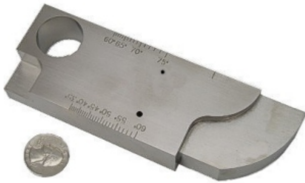
MINI TBIIW-TYPE 2, METRIC, 25x20x150mm. Mini etalonas keitiklių kalibravimui.
