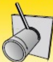
Vertikaliąjį žemyn, vamzdis pasukamas, vamzdis lo ašis horizontalioje padėtyje: PB/2FR
