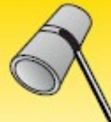
Vertikaliąjį žemyn, vamzdis nepasukamas, vamzdis lo ašis horizontalioje padėtyje: PG/5G (5Gd)
