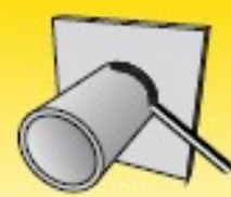
Vertikaliąjį žemyn, vamzdis nepasukamas, vamzdis o ašis horizontalioje padėtyje: PG/5F (5Fd)
