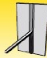
Vertikaliąjį aukštyn: PF/3G (3Gu)
