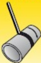
Žemutinė, vamzdis pasukamas, vamzdis o ašis horizontalioje padėtyje: PA/1G
