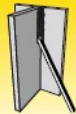
Vertikaliąjį žemyn: PG/3F
