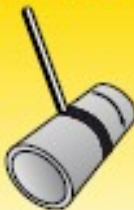
Žemutinė, vamzdis pasukamas, vamzdis lo ašis horizontalioje padėtyje: PA/1G
