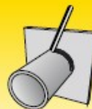
Vertikaliąjį aukštyn, vamzdis nepasukamas, vamzdis lo ašis horizontalioje padėtyje: PF/5F (5Fu)
