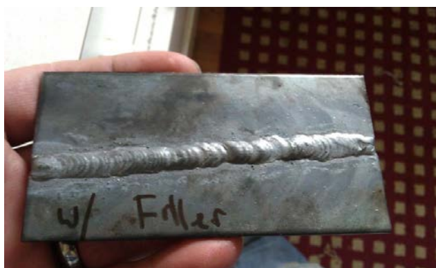
Plieninių plokščių dujinio suvirinimo sandūrinė jungtis
