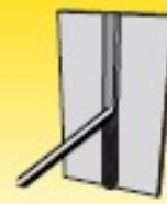
Vertikaliąjį aukštyn: PF/3G (3Gu)
