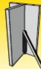
Vertikaliąjį aukštyn: PF/3F (3Fu)
