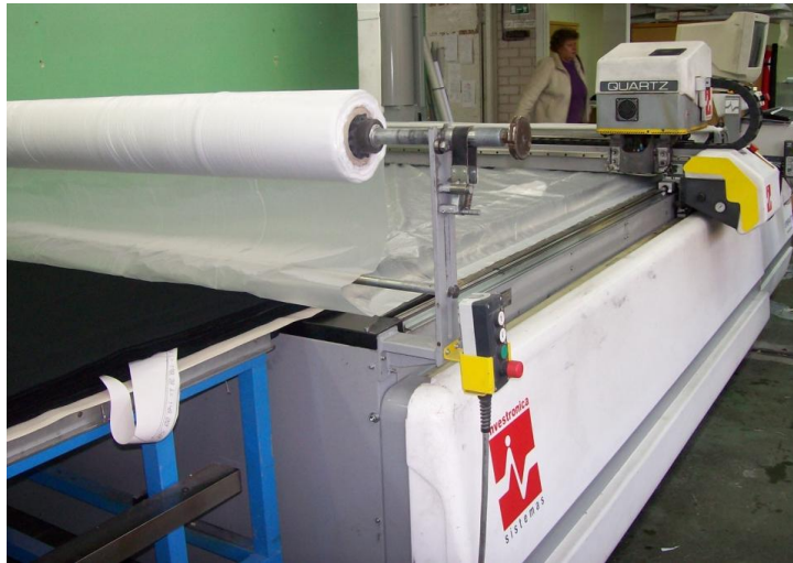
8 pav. Plėvelės tiesimas ant klojinio
