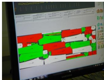
6 pav. Kombinuota išklotinė, kai trys lekalų komplektai yra tarpusavyje sumaišyti siekiant išskirtinio ekonomiško
