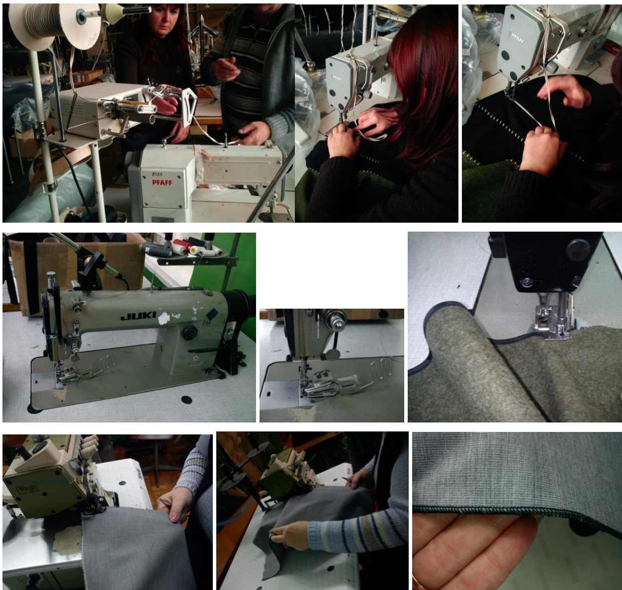
12 pav. Siuvimo mašinos su apdailai skirta mažąją mechanizaciją
