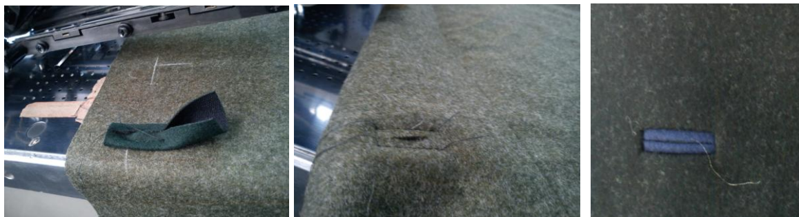
13b pav. Drabužio kilpų apsiuvų siuvimas iš kito audinio
