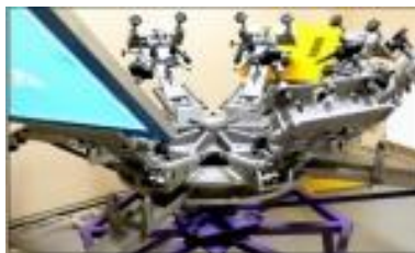
11 pav. 8 spalvų karuselinės staklės tekstilės marginimui
