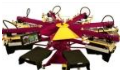
12 pav. Automatinės karuselinės šilkografijos staklės 8/6
