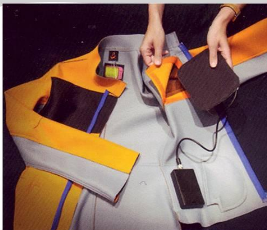
Mikroelektronikos integracijos pavyzdys - France Telekom striukė.
