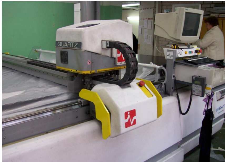
64 pav. Automatinis sukirpimo/supjovimo įrenginys INVESCUT QUARTZ
