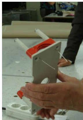
55 pav. Įtaisas klojinio sluoksnių sutvirtinimui
