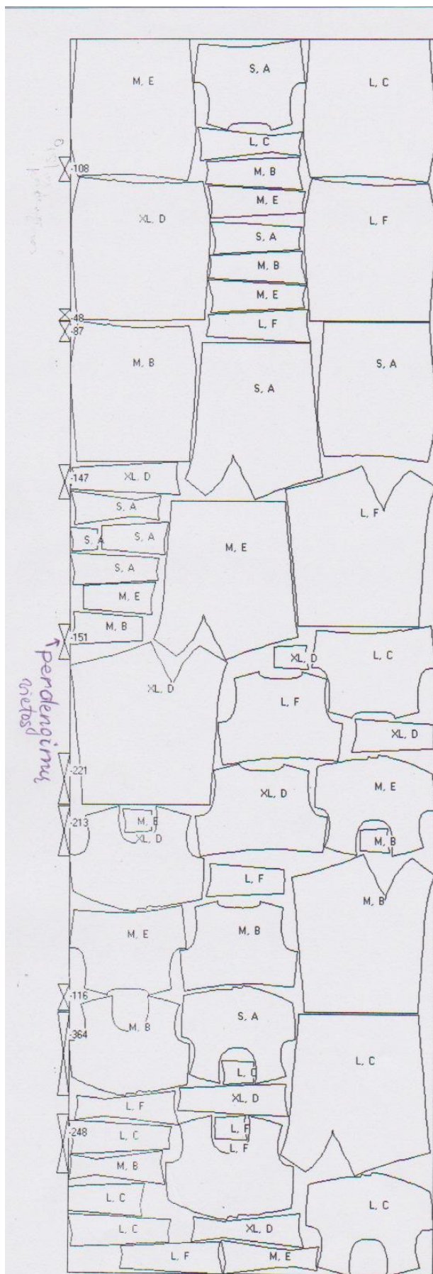
28 pav. Lekalų išklotinė su perdengimų vietų nuorodomis
