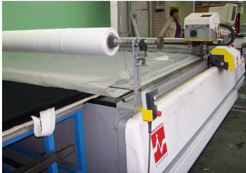
63 pav. Plėvelės tiesimas ant klojinio
