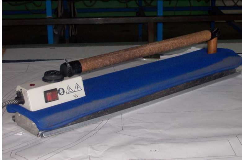
50 pav. Specialus lygintuvas išklotinės klijavimui
