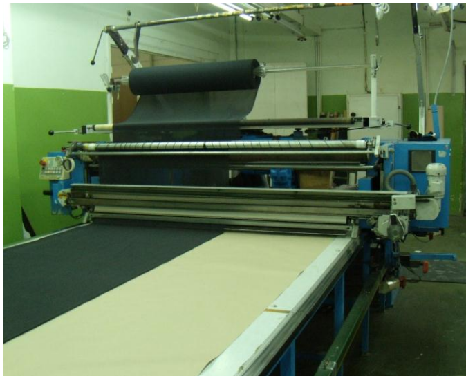
31 pav. Automatinė klojimo mašina Bullmerwerk
