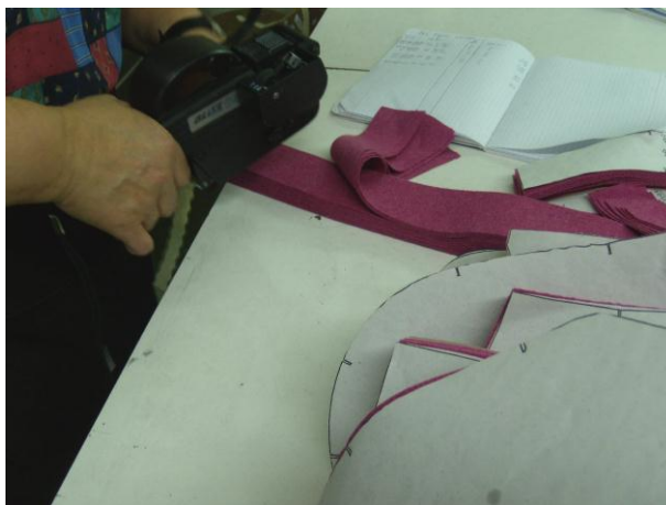
59 pav. Detalių numeravimas aparatu Blitz
