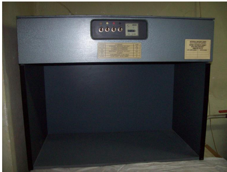
38 pav. Ultravioletinės šviesos dėžė kokybės tikrinimui
