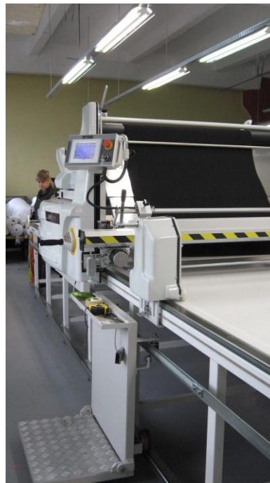
15 pav. Automatinė klojimo mašina SERKON
