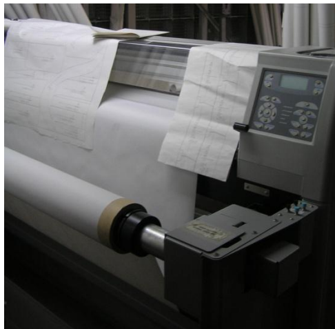
1.3.36. Pav. Išsklotinių dauginimo įrenginys – spausdintuvas
