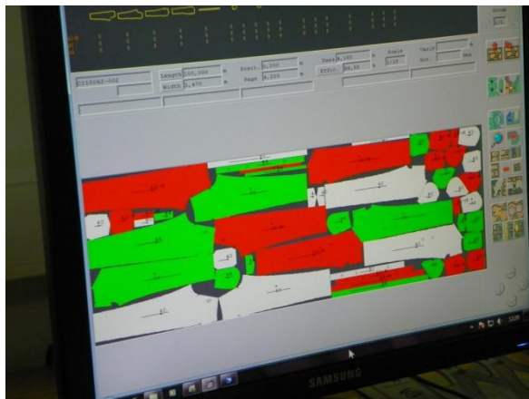
1.3.35. Pav. Kombinuota išklotinė, kai trys lekalų komplektai yra tarpusavyje sumaišyti siekiant išskirtinio ekonomiško
